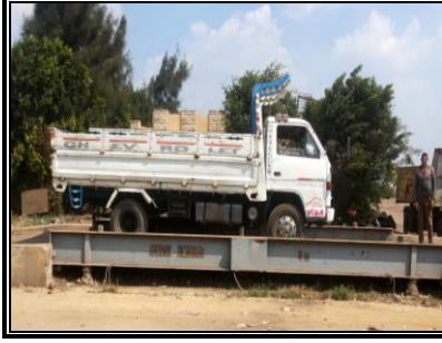
صورة (٢-١) دخول العربات محملة بالقمامة ووزنها (ميزان بسكول)، ثم كب القمامة وفتح حاوياتها
