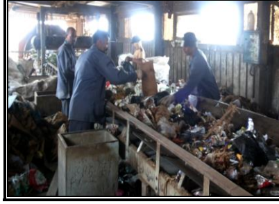
صورة (٣-٤) رفع القمامة وإدخالها إلى وحدة الفرز عبر السير الناقل وفصلها بغرف الفرز الفرعية
