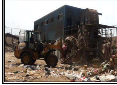
صورة (٣-٤) رفع القمامة وإدخالها إلى وحدة الفرز عبر السير الناقل وفصلها بغرف الفرز الفرعية
